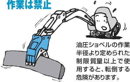
油圧ショベルの作業半径より定められた制限質量以上で使用すると、転倒する危険があります。
