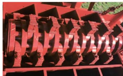
伝達効率の高いエンジン直接駆動方式の破砕ローターで、パワフルな破砕を実現
