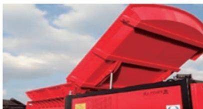
油圧チルト式ホッパーにより、円滑な材料投入を実現
