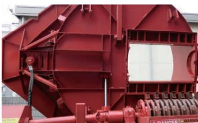
油圧式開閉タブの採用により、ツールやスクリーンの交換が容易に
