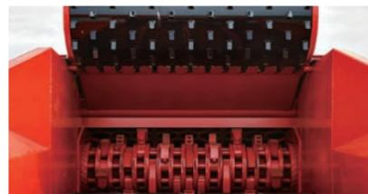
チェーンベルトと大径フィードロールで、安定した供給と大量の処理が可能
