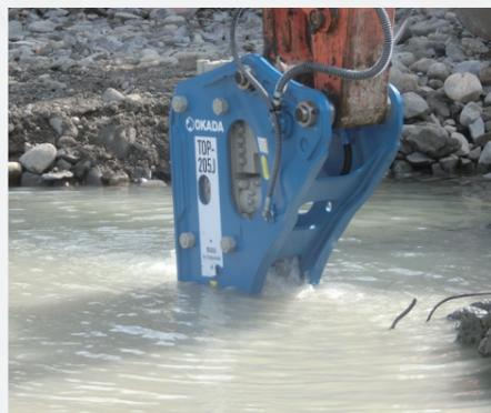
ブレーカ内部にコンプレッサーでエアーを供給し、水の侵入を防ぐことにより、水中での破碎作業が行えます。(TOP-110J~800J)
