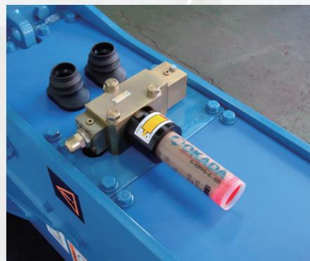
電気配線が必要とせず、TOP-110J以上に取り付ける事ができ、チゼルやブッシングの長寿命化を図り、メンテナンスのための休止時間を削減します。取付ショベルを選ばず、稼働時間中だけ給脂します。(TOPV-100は除く)
