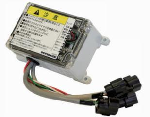
コンパクトなコントロールボックスはキャビン内空間を圧迫せず、動作電源はシガーソケットまたはヒューズボックスから取り出すため、簡単に取付・取外しが可能。
