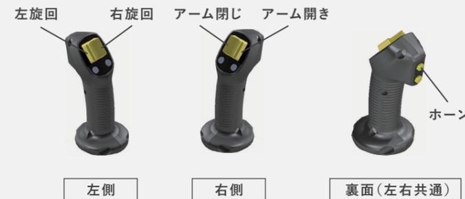
油圧ペダルを踏みながら、左右のグリップスイッチでアタッチメントを操作。直感的で、操作性に優れた形状です。操作速度はペダルの踏み量で調節します。
