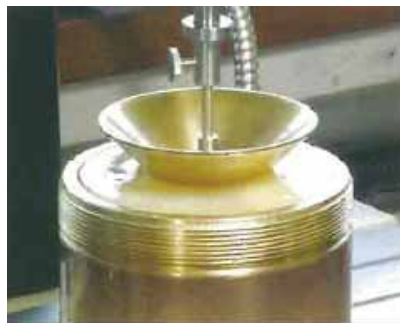
規定円錐が進入した深さを測定します。
