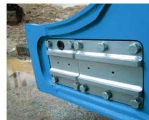
メンテナンスがしやすい大きな点検口
