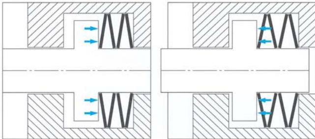
ゆるみによるガタつきと衝撃が破損の最大原因です。
