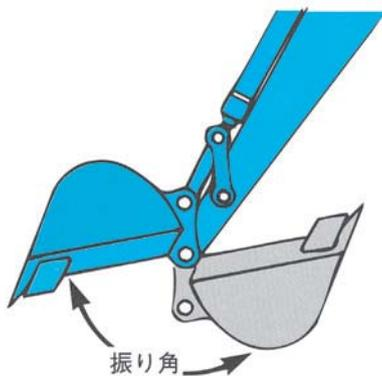
バケットのピン間距離が数センチ違うだけで、バケットの「振り角」は大きく変わります。
