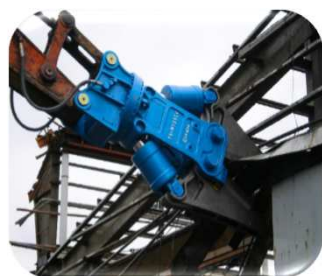
ビル解体用 圧碎機（鉄骨カッター）
