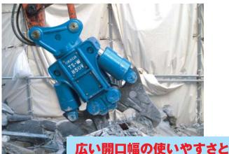
ウェッジアームによる 抜群のくい込みで、 作業性は大幅にアップします
