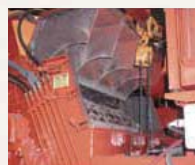
油圧式開閉フードにより、スクリーンの交換が簡単にスピーディに行えます。
