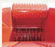
チェーンベルトと大径フィードローにより、安定した供給と大量の処理が可能です。
