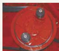
異物混入時、衝撃や過負荷からエンジンやクラッチを保護するトルクリミッターを装備。
