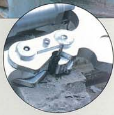
鉄筋切断もOK。
