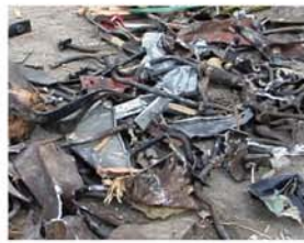
磁選機により除去された金属類
