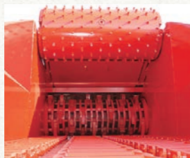
チェーンベルトと大径フィードロールにより、安定した供給と大量の処理が可能です。
