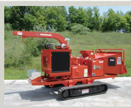
エンジンにはカバーを装備し、周辺環境やオペレーターに配慮した安全な設計。
