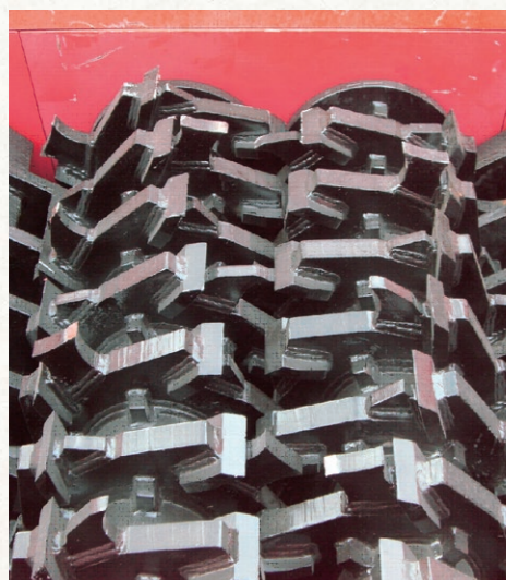
独自の破砕刃形状と中低速回転によりさまざまな廃棄物をパワフルに破砕。
