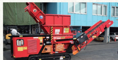
破砕ドラムへスムーズに木材を投入することができるリフトアップ式ホッパー。
