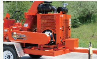
エンジンにはカバーを装備し、周辺環境やオペレーターに配慮した安全な設計。
