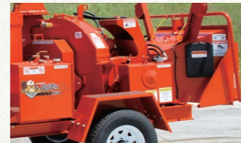
メンテナンスフードの開閉でナイフ(破碎刃)やアンビル(受刃)の交換が容易。
