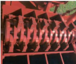
伝達効率の高いエンジン直接駆動方式の破砕ローターで、パワフルな破砕が行えます。
