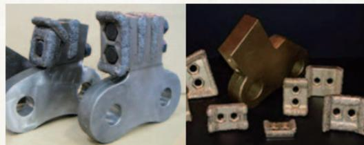
破砕刃には、ロングライフの高耐久タンガステンカーバイトを採用。(標準品は先端ツース交換タイプです)
