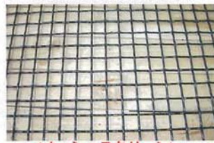
<メッシュスクリーン> 1 段目・2 段目のスクリーンに使用
