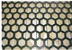
<パンチプレート> フィーダー落ち口に使用し 材料の拡散に効果を発揮
