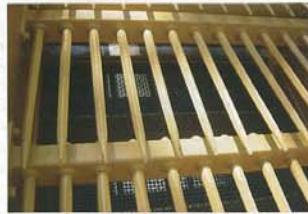
<フィンガースクリーン> 大塊の原石やコンクリートガラ からみつきやすいビニールシート テープ類の入った混合廃棄物に
