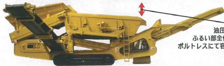
<ハーブスクリーン> 粘性の高い材料のアンダー材選別
